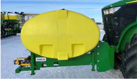
Réservoir de 200, 300, 400 ou 500 gallons installé sur le support à pesées
