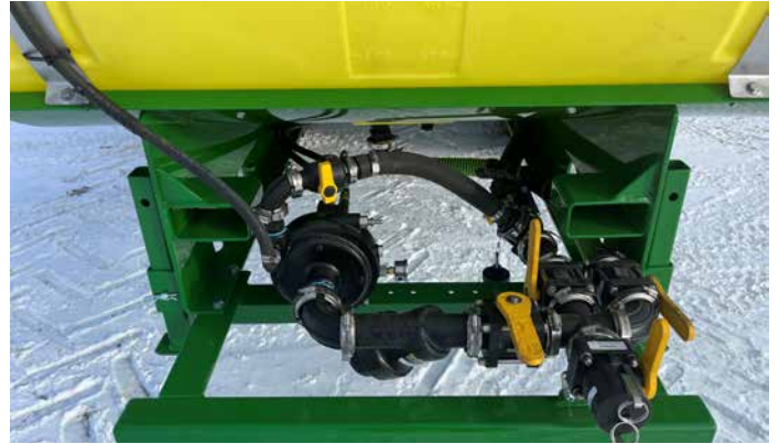
Pompe centrifuge wet seal avec chargement 2 pouces du réservoir avant et arrière
