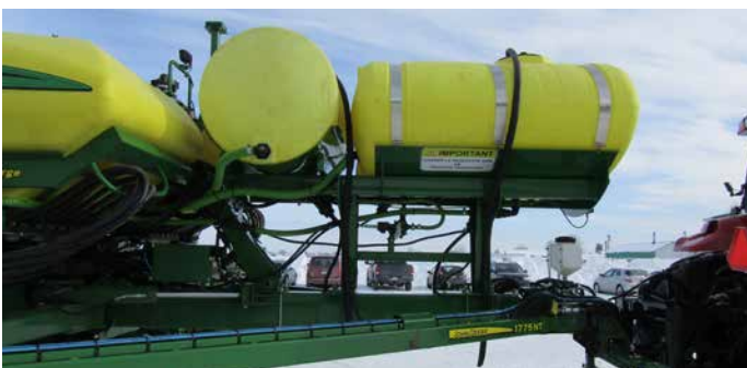
Installation d'un réservoir de 200 et 500 gallons sur planteur 12 rangs, pour planteur 16 et 24 rangs, réservoir de 300 et 600 gallons
