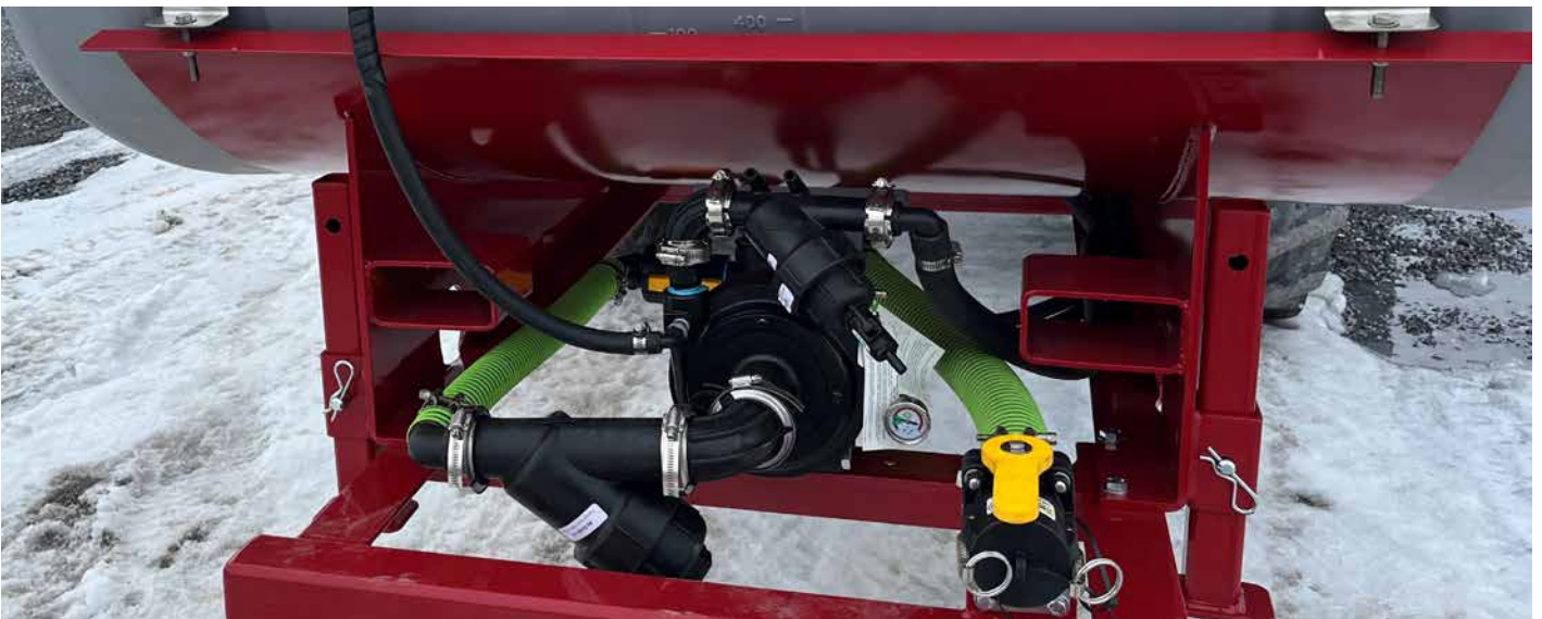
Pompe centrifuge wet seal avec chargement 2 pouces du réservoir avant
