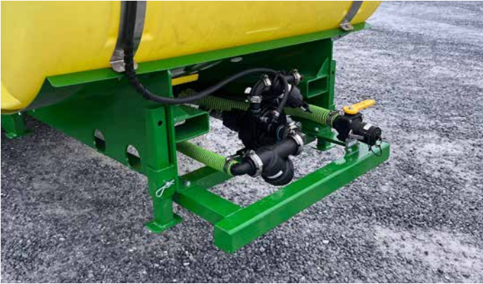
Pompe centrifuge wet seal avec chargement 2 pouces du réservoir avant
