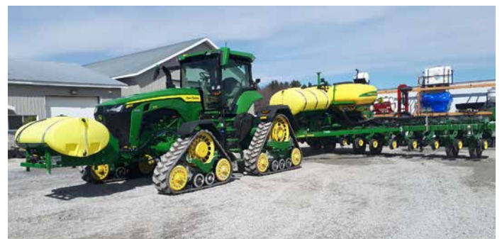
Installation d'un réservoir 300 gallons sur tracteur série 8RX pour application de pop-up. Réservoir 600 gallons sur planteur 1775 NT pour application d'azote au disques
