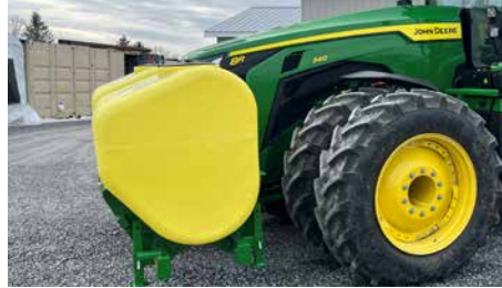
2 réservoirs de 250 ou 300 gallons soit sur 3 points ou fixé à la place du support à pesées
